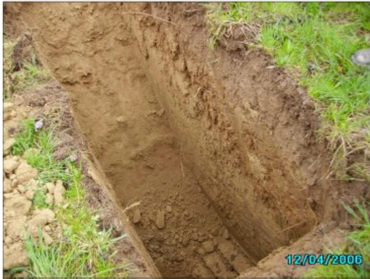
Abb. 13 aufgeschlossene Lockergesteinsdecke im Bereich von Schurf 4
