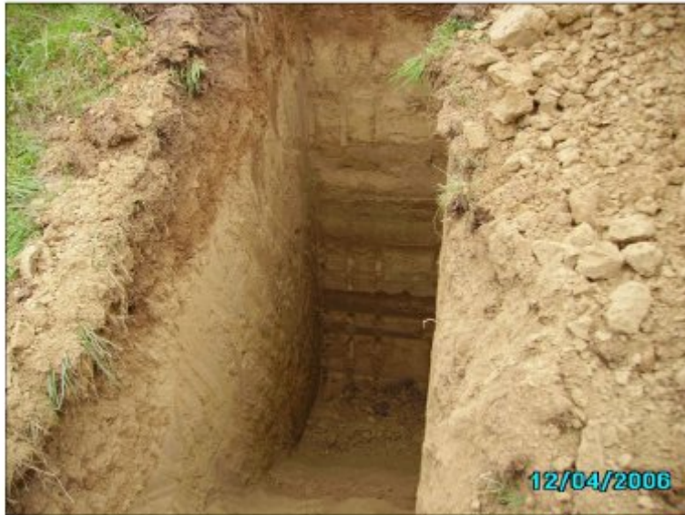
Abb. 11 aufgeschlossene Lockergesteinsdecke im Bereich von Schurf 3
