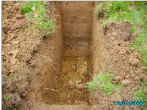
Abb. 6 Erkundungsschurf zum Versickerungsversuch VV 2. In der Schurfsohle kalkiger verlehmtter Hangschutt
